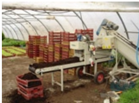
L'outillage doit aussi permettre au travailleur de se libérer des tâches pénibles. Ici, une machine à remplir les pots...
